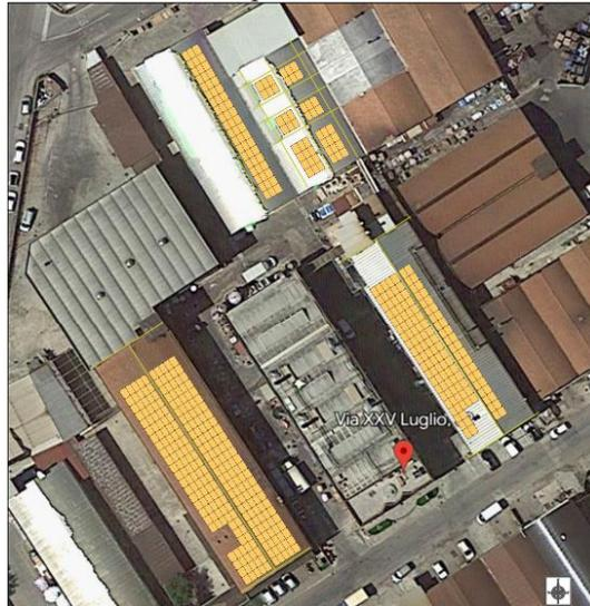
Figura 25 – Foto aerea stabilimento con lay-out coperture fotovoltaiche
